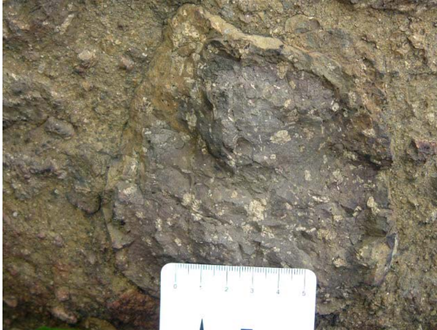
Figura 1: Geometria aproximadamente esférica e presença de fina margem resfriada em bombas de aglomerados do Complexo Vulcânico de Nova Iguaçu.
